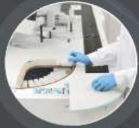
2~8 °C soğutmalı reaktif karuseli 36 pozisyona sahiptir
